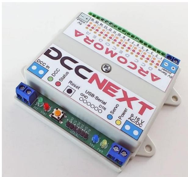
Dieser Decoder kann sowohl mit Schraubklemmen als auch mit Dupont-Steckern ausgestattet werden. Ein Servo kann somit direkt an die Pins angeschlossen werden. Zu diesem Zweck ist auch eine separate 5V-Servoversorgung vorgesehen.
